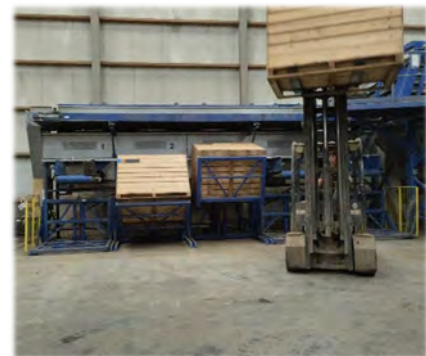
Calibreur et mise en palox
