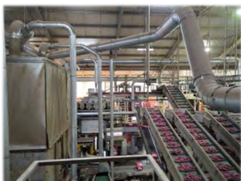
Sortie du calibreur et envoi vers les trieurs optiques
