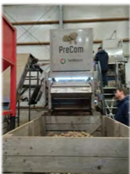
Le trieur optique et les écarts de tri
