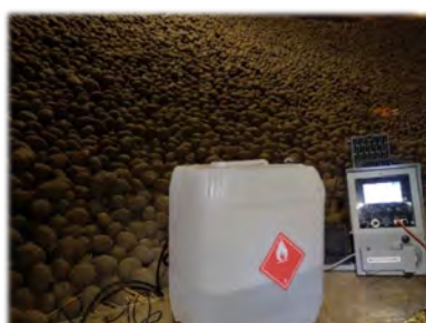
Générateur Ethylène Stockage C
