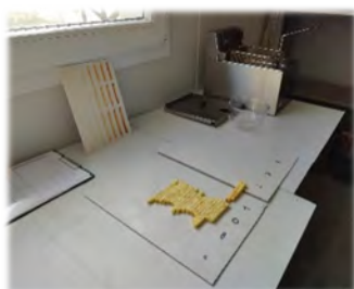
Notation coloration des frites 3 min à 180 °C
