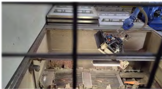
Effeuilleuse avec grilles en cours de changement par le robot
