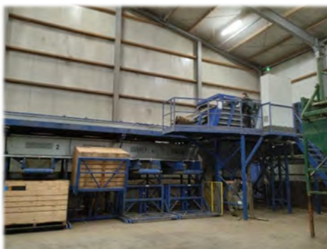
Calibreur et mise en palox
