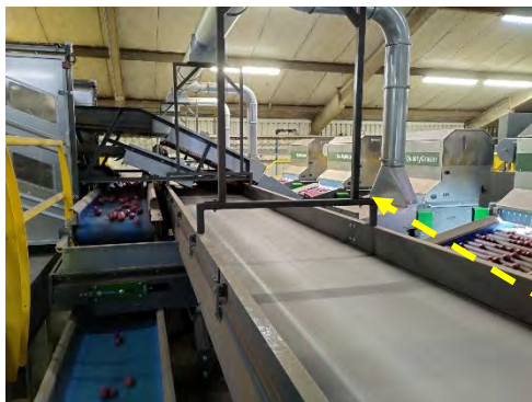
Sortie du calibreur et envoi vers les trieurs optiques
