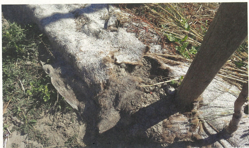
Au bout de deux ans, le paillage 70 % jute-30 % sisal montre d'importants signes d'usure.
