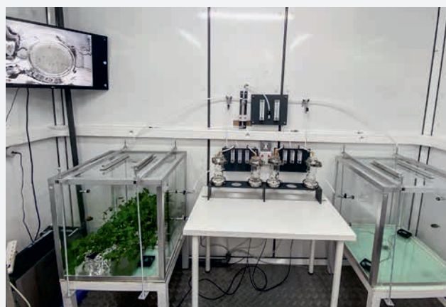
Figure 6 | Olfactomètre tubulaire dynamique mis au point par l'INRAE (UMR PSH) Crédit : UMR PSH
