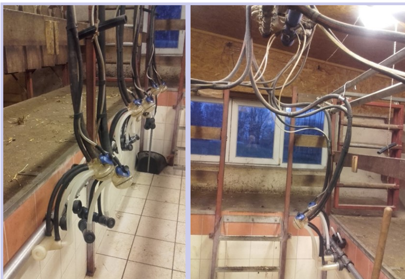
Ligne haute double quai avec 8 postes chèvres et 8 postes brebis (pulsation permutable)
