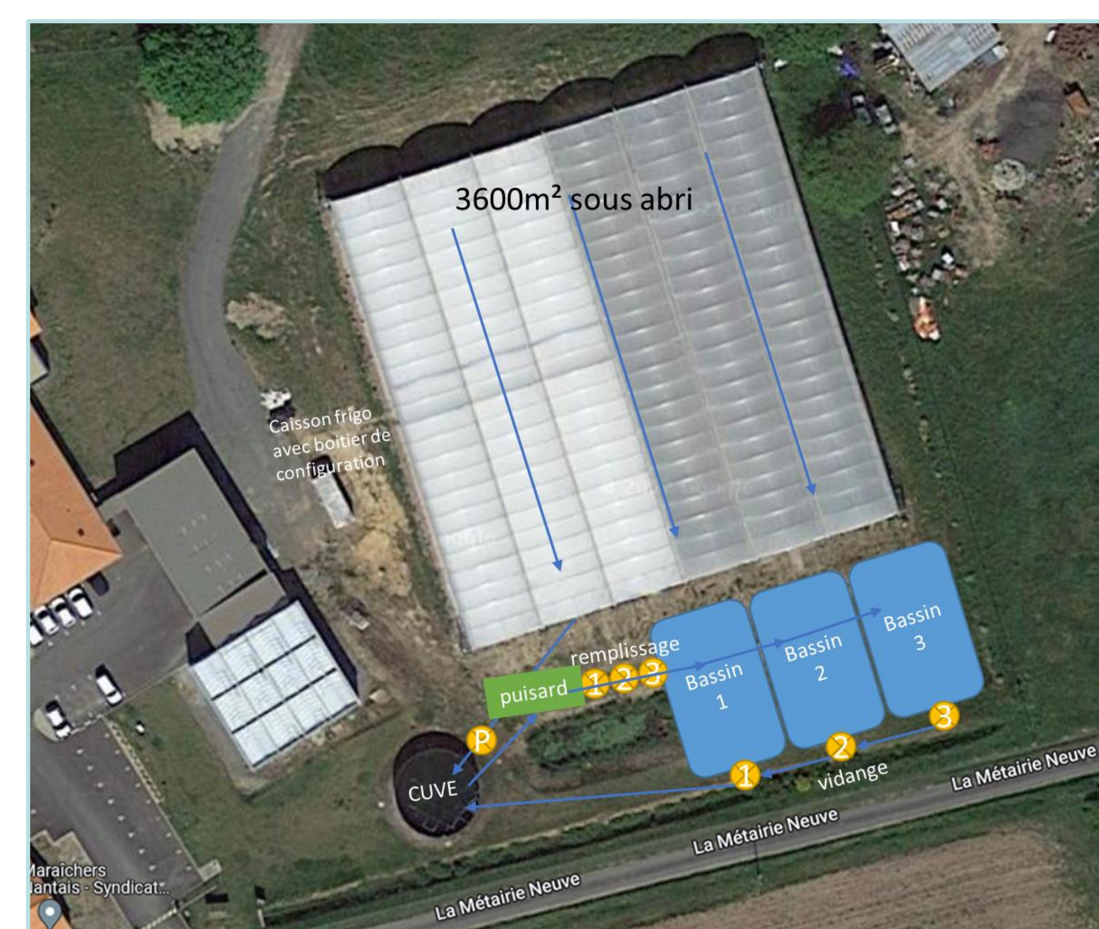
Vue aérienne du site expérimental avec surface de collecte sur les serres et emprise au sol
