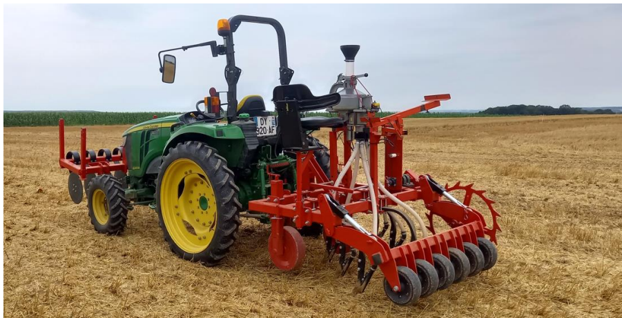
Dents de semis non vibrantes équipées de pointes fines de 12 mm
