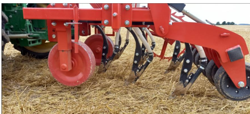
Disques à l'avant pour faciliter la progression de la dent dans les couverts développés (Aucun angle par rapport à l'avancement ou par rapport à la verticale)
