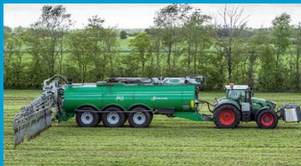
Le système d'acidification du lisier à l'épandage est efficace mais peu répandu en France. ©Samson
