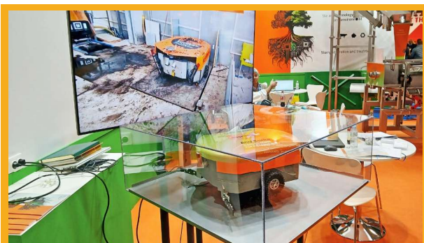
L'AGV Sucker de chez Segalès descend dans les préfosse pour aspirer le lisier.
