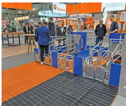
Big Dutchman (Pays-bas) présentait des maternités avec courette collective à l'arrière. Différents portillons permettent de libérer la truie, les porcelets ou les deux.
