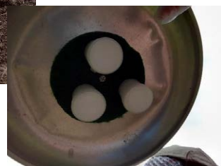
Capteurs passifs ALPHA (Adapted Low-Cost Passive Absorption) pour mesure des concentrations d'ammoniac au champ (METIS INRAE Transfert).
