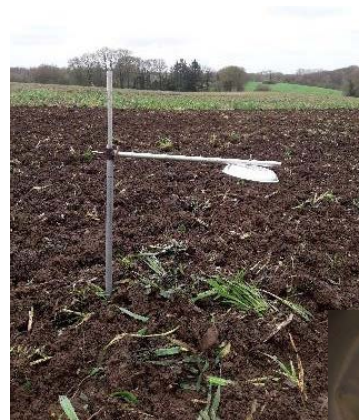
Capteurs passifs ALPHA (Adapted Low-Cost Passive Absorption) pour mesure des concentrations d'ammoniac au champ (METIS INRAE Transfert).
