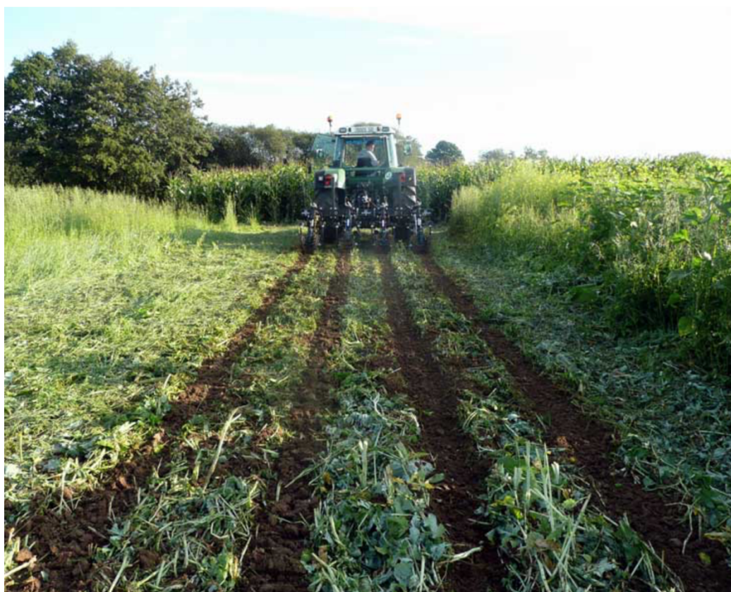
Figure 5 : Technique du strip-till visant à travailler uniquement les futurs rangs de semis [agriculture de conservation].
