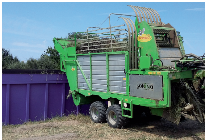
Faucheuse-autochargeuse en train de vider dans un caisson de distillation
