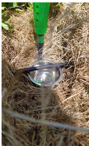
Test de débit sur gaine de goutte-à-goutte (source : GAB72)
