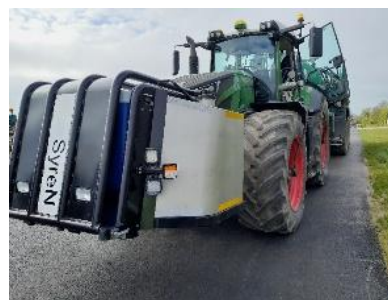
Figure 1 : Cuve transportant l'acide à l'avant du tracteur dans le système Syren.
