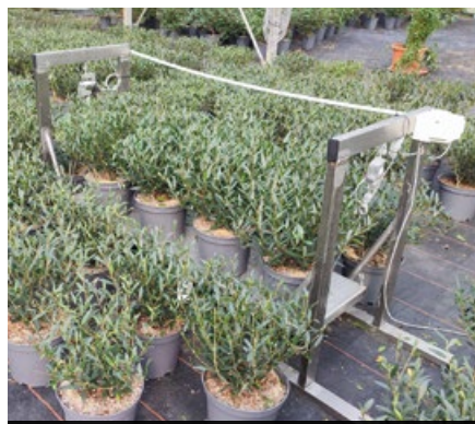
Photo n°11 : balance connectée permettant le pilotage de l'irrigation.
