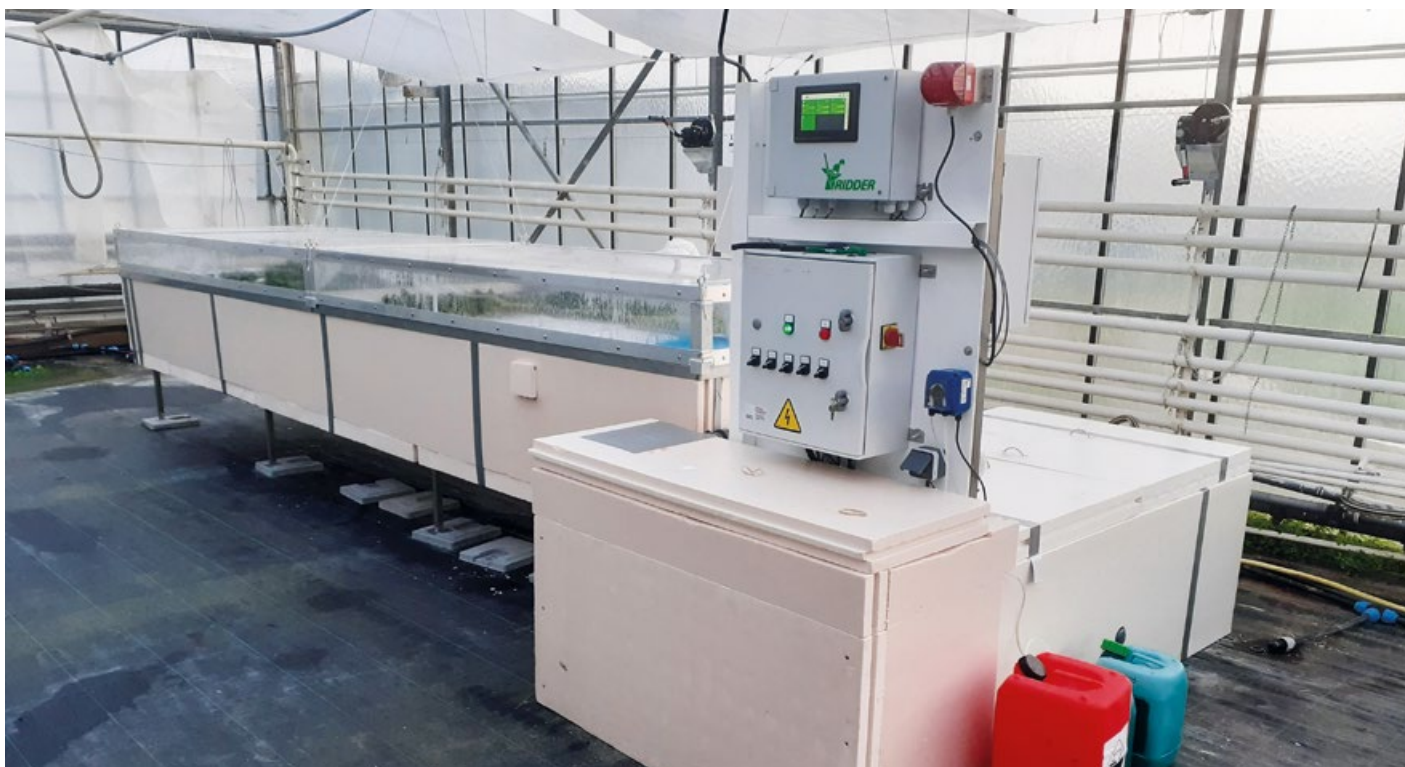
Photo n°4 : prototype de bouturage par aéroponie mis en place au Caté dans le cadre du projet Racin'Air. Au premier plan, unité de stockage et de traitement de l'eau. Au second plan, table de bouturage. Le dispositif est isolé pour limiter les déperditions énergétiques.
