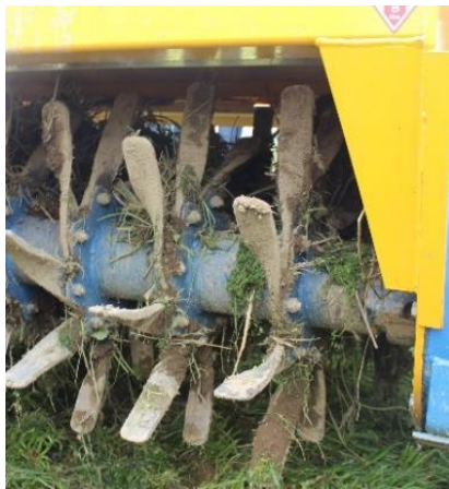
Dyna-drive : le premier rouleau entraîne le deuxième (pas de prise de force).
