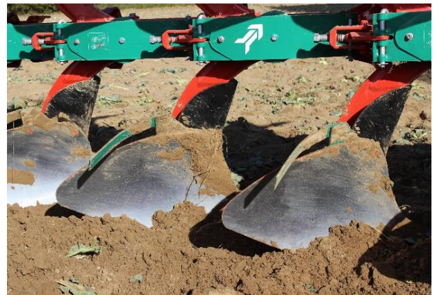
Charrue déchaumeuse (travail superficiel sur environ 10 cm)
