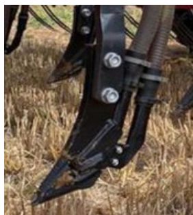
Différents profils de dents pour semis direct
