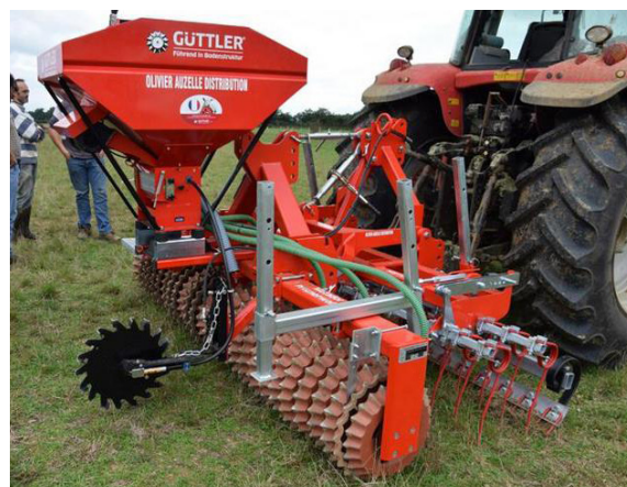
Le semoir Gütthler intègre un semoir à la volée autour d'un ensemble de travail superficiel (barre nivelleuse, herse, rouleau « pieds de moutons »).
