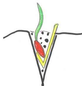
Le disque peut pincer un débris au fond du sillon
