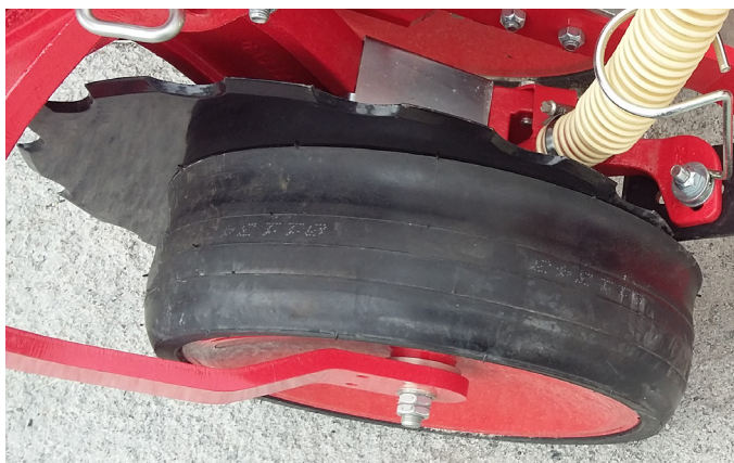
Contrôle de la profondeur de semis « à l'américaine » sur semoir Maschio Gaspardo
