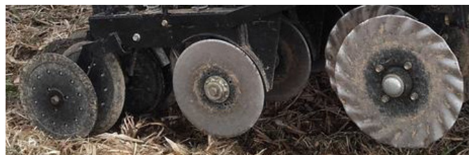
Des disques ouvreurs gaufrés précèdent les disques semeurs (semoir Great Plains 3P1006NT)
