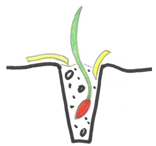
La dent crée de la terre fine et laisse les débris en surface
