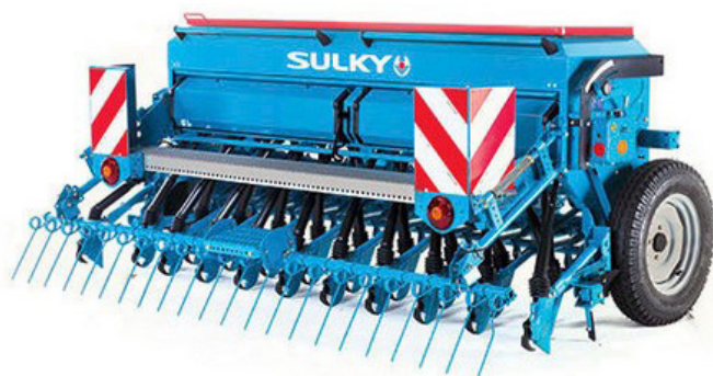
Sur les semoirs traditionnels, la trémie occupe toute la largeur de l'outil (source SULKY)
