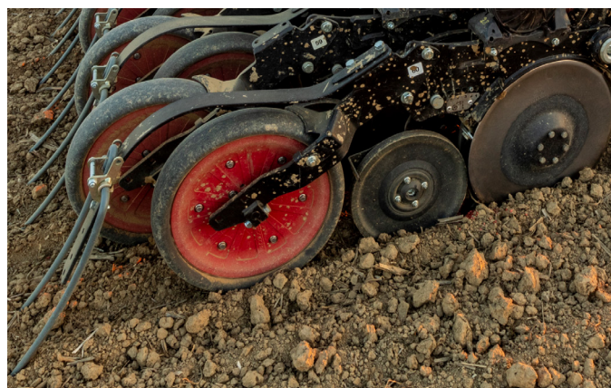
Roues de rappui et herse derrière des disques semeurs (source HORSCH)
