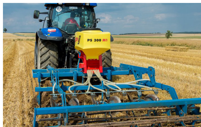
Semoir APV à transport pneumatique monté sur un déchaumeur
