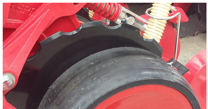
Disque semez crénelé sur semoir Maschio-Gaspardo
