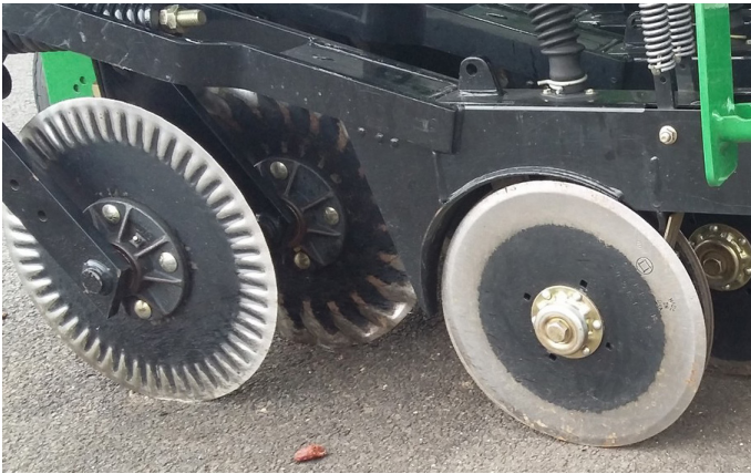
Disque gaufré à l'avant des disques semeurs
