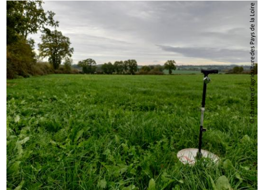
Herbomètre pour mesurer la hauteur d'herbe
