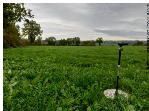
Herbomètre pour mesurer la hauteur d'herbe
