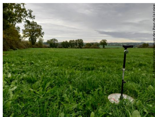
Herbomètre pour mesurer la hauteur d'herbe
