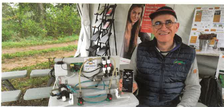
Christophe Auvergne, de la chambre d'agriculture de l'Hérault présente le système Débitdouille pour contrôler en temps réel le débit des pulvérisateurs.
