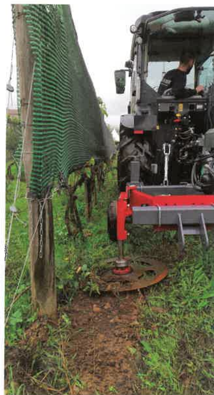
L'interceps de Ferotin a la particularité de couper l'herbe sur les trois premiers centimètres du sol.
