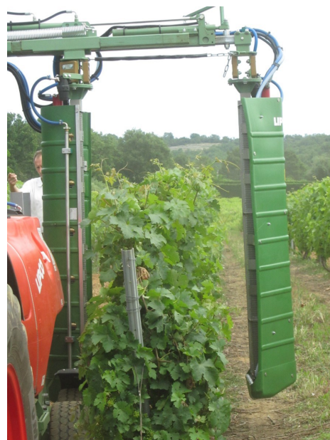
Utilisation de panneaux récupérateurs
