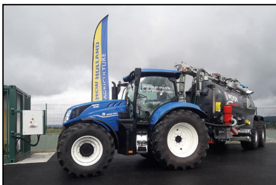
Exemple de tracteur au biométhane
