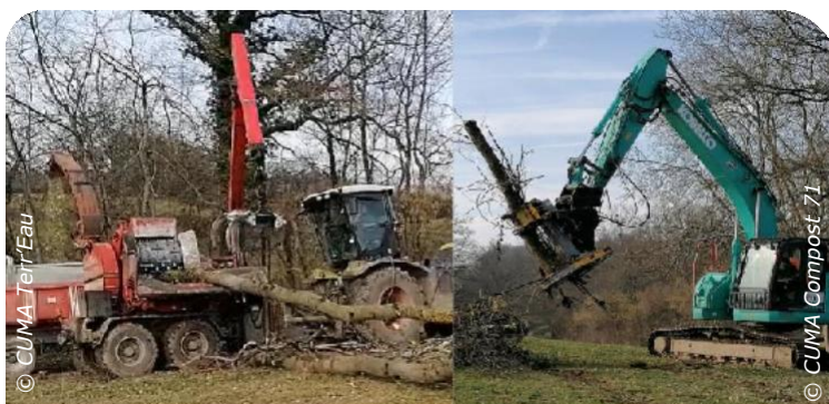
Broyeur à bois plaquette (à gauche) et grappin-coupeur (à droite)
