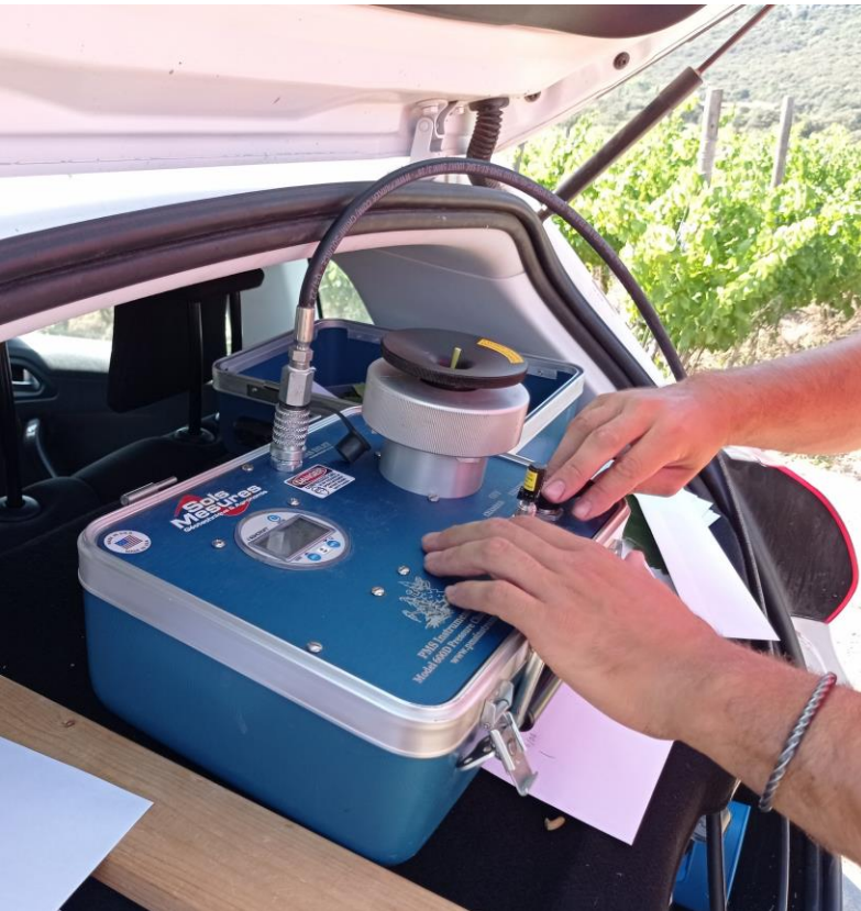
Mesure de potentiel hydrique de tige à la chambre à pression
