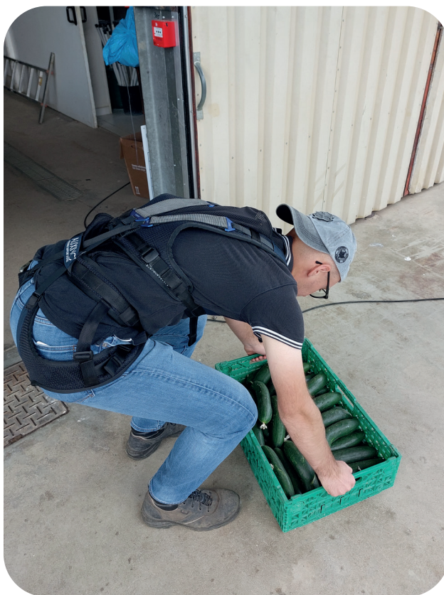
Test de l'exosquelette Liftsuit
