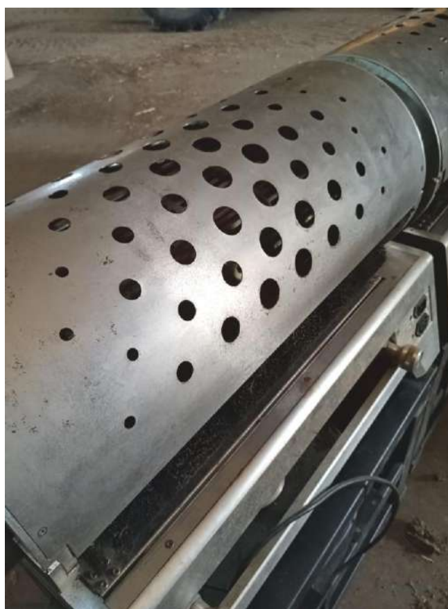
Trimeuses permettant de séparer certaines parties de la plante mécaniquement.
