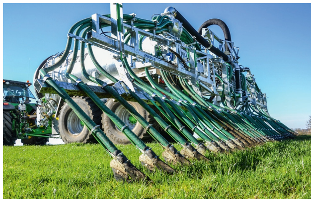
Les rampes à pendillards permettent de diminuer de 30 à 65 % les émissions d'ammoniac. ©Reussir
