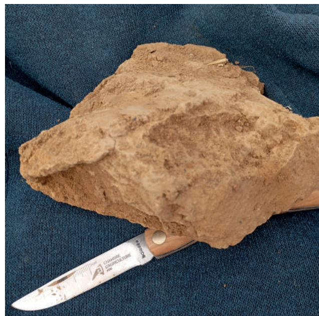
Figure 7 : Mottes compactes sans signe de porosité
