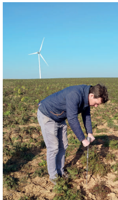
Figure 6 : Utilisation du pénétromètre simple et efficace
