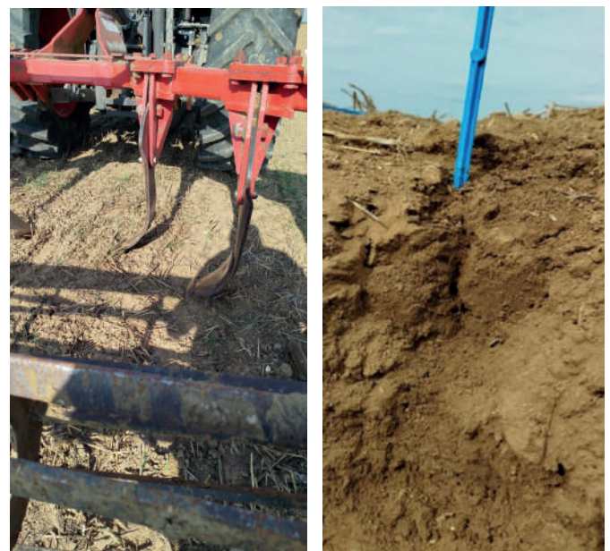
Figure 10 : la dent Michel et son travail de fissuration horizontal et vertical
