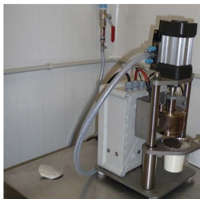
Petite conditionneuse de produits laitiers frais.
