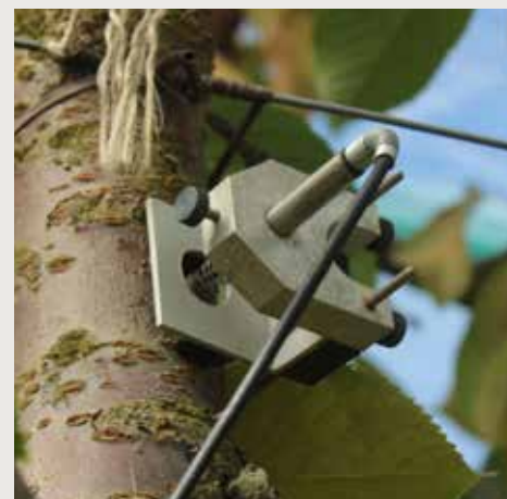
Les dendromètres sont équipés d'un capteur qui mesure automatiquement les variations quotidiennes des diamètres de tiges ou de branches.
