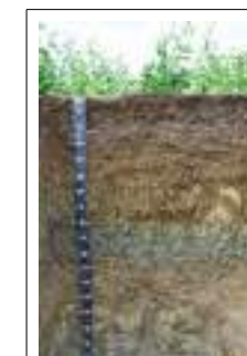
F57083 – UC 3210 Sol brun calcaire hydromorphe sur dolomie en dalle du Trias
