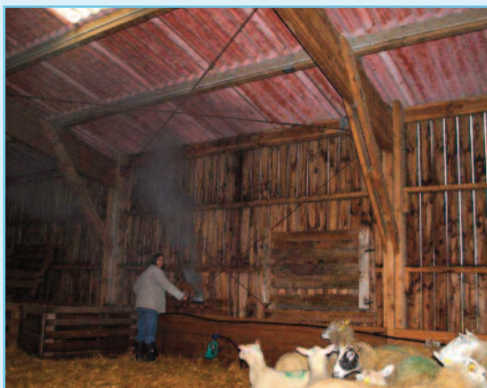
Sur la photo, le test est réalisé vers les entrées d'air.
