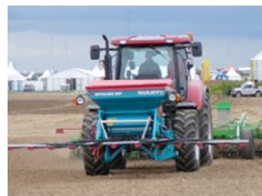
Semis à la volée précédent le passage d'un outil à dents
