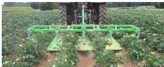
Le buttoir scalpeur permet de désherber les flancs de la butte tout en la restructurant et recouvrant les adventices.
