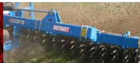
La houe rotative est un outil de désherbage mécanique efficace à un stade précoce des cultures. Utilisée en plein, elle est sélective sur de nombreuses espèces. Cet outil peut permettre également d'écroûter le sol. Il est particulièrement adapté aux sols battants. Il existe plusieurs types de houe rotative qui se différencient par le type de matériaux de construction, la disposition des roues et les possibilités de tension au travail.
