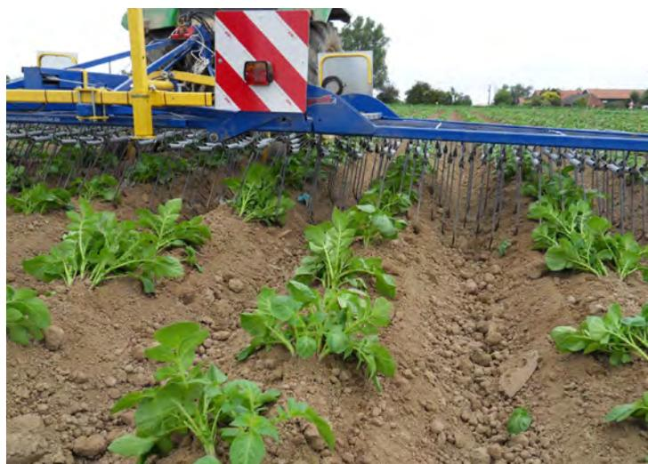
L'utilisation de herse type Treffler permet un travail par extirpation plus précis et une action des dents homogène du sommet au fond de butte. Ces passages à la herse sont cependant facultatifs car certains matériels buttent et hersent en même temps. Un dernier buttage remonte la terre le plus haut possible pour couvrir et éliminer les mauvaises herbes avant la fermeture des rangs par la végétation.
