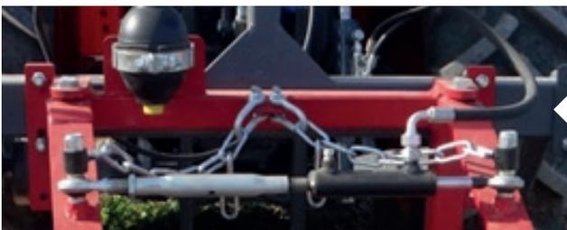
Système hydraulique avec azote stable Vérin
