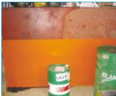
Rétention métallique pour huiles usagées
