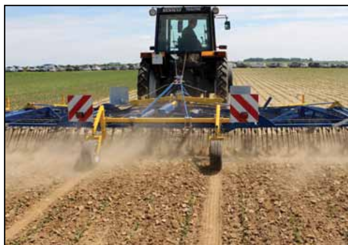
■ La herse étrille agit par déracinement des adventices, son réglage est simple.
