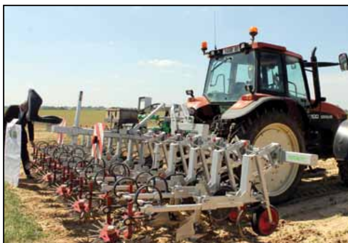
■ Avec les outils de guidage et les moulinets, les bineuses permettent d'obtenir de bonnes efficacités avec des débits de chantier de 2 à 4 ha/h.
