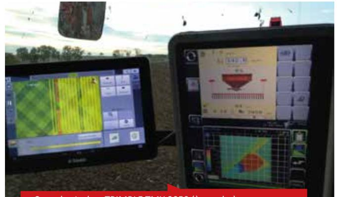
Consoles Isobus TRIMBLE TMX 2050 (à gauche) et Isomatch Tellus VICON (à droite) utilisées sur la Ferme 3.0
