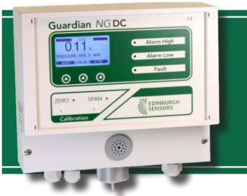
Un détecteur de gaz à absorption infrarouge non dispersif (NDIR) – Guardian NG d'Edinburgh Sensors (Edinburgh Instruments Ltd) a été utilisé dans l'expérimentation.
