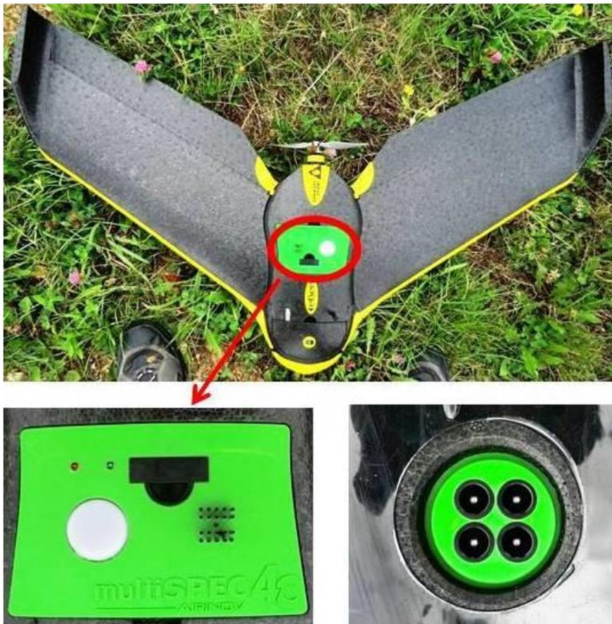
Figure 19 : Drone et caméra multispectrale
