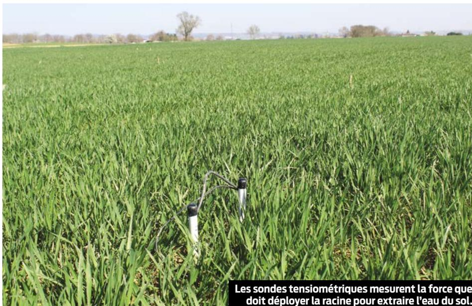
**Les sondes tensiométriques mesurent la force que doit déployer la racine pour extraire l'eau du sol.**
