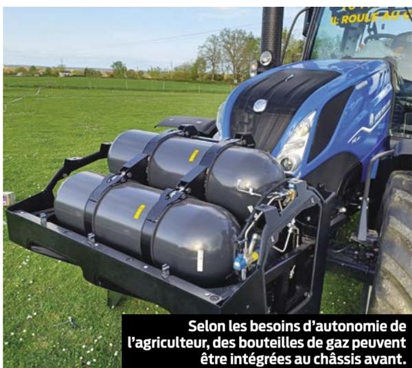
Selon les besoins d'autonomie de l'agriculteur, des bouteilles de gaz peuvent être intégrées au châssis avant.
