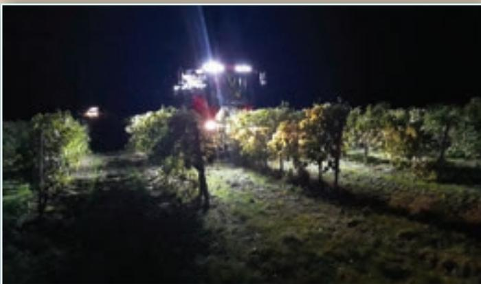
**Résultats** : la mesure des pertes à la vigne à l'aide de bâches poids-lourd, corrobore bien la pesée et laisse apparaître une perte de jus de plus de 10 HL/ha pour une machine. Du côté consommation de GNR, l'écart est de 30 % entre les machines dans la vigne comme lors des déplacements sur route. Ces tests ont été conduits avec le journal « Le Paysan Vigneron ».
