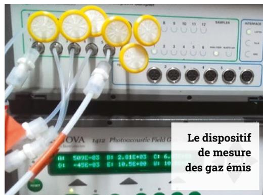
Le dispositif de mesure des gaz émis
