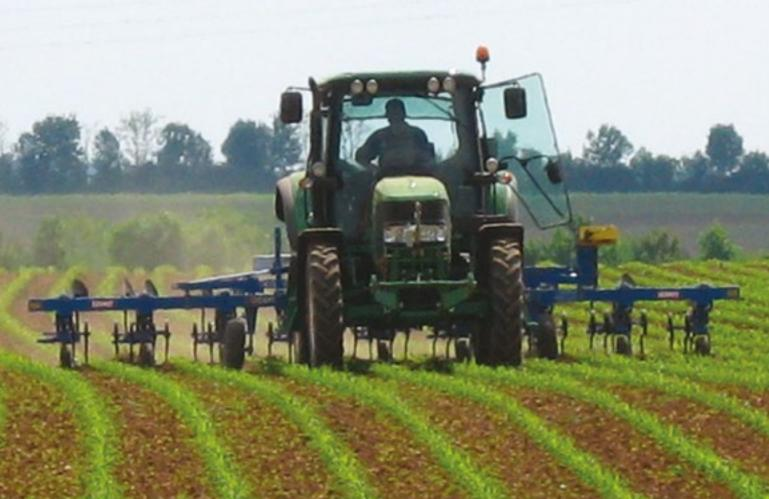
La bineuse est efficace en inter-rang sur des adventices développées et permet de limiter le développement de celles présentes sur les rangs en réalisant un buttage. Le nombre de rangs de la bineuse doit être identique à celui du semoir et la largeur des inter-rangs doit être constante notamment entre les coups de semoir.
