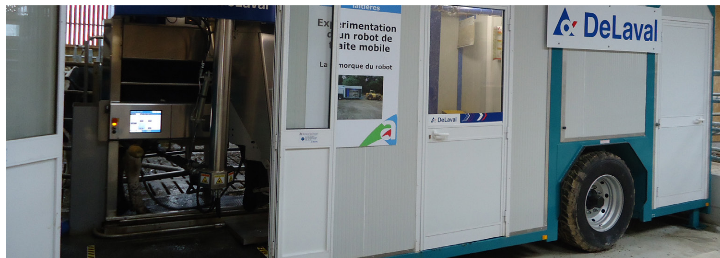
▲ Vue d'ensemble de la remorque abritant le robot, placée dans la stabulation durant la phase hivernale
