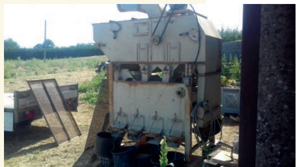
Trieur séparateur à grilles ou pré-nettoyeur.
