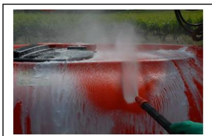
Le lavage s'effectue en deux temps : pulvérisation de détergent par jet basse pression puis nettoyage grâce au jet haute pression
