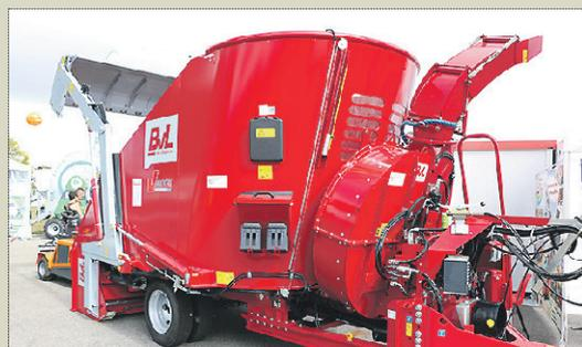
La scie de désilage de la désileuse-mélangeuse-pailleuse V-Mix Fill de BVL bénéficie désormais d'un dispositif de graissage automatique simplifiant son entretien et optimisant sa durée de vie. Pour limiter la puissance du tracteur à 80 ch, le constructeur équipe la turbine de paillage d'une assistance hydraulique limitant l'effort au démarrage.
