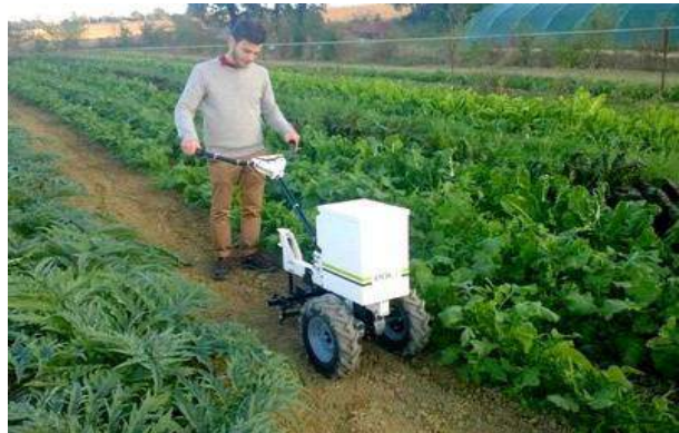
Motoculteur électrique Cosi : biner sans bruit et sans gaz d'échappement
