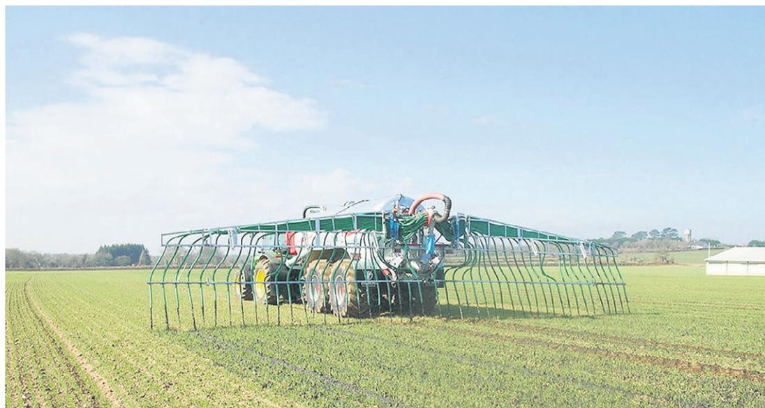
> Le pendillard permet en déposant le lisier au sol d'éviter au moins 50 % de la volatilisation, comparé à une buse qui brasse le produit en l'air lors de l'épandage.
